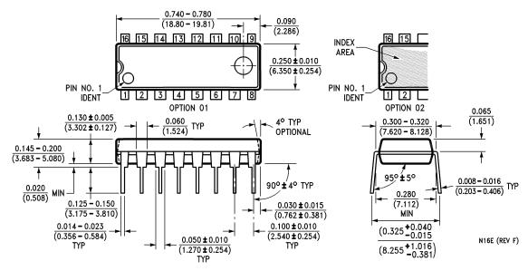
Molded Dual-In-Line Package (N) Order Number DS26LS31CN NS Package Number N16E
