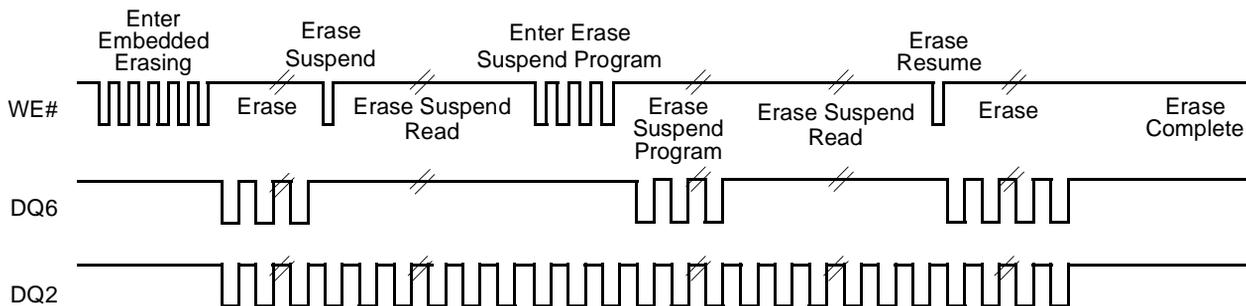
**Note:** The system may use CE# or OE# to toggle DQ2 and DQ6. DQ2 toggles only when read at an address within an erase-suspended sector.
