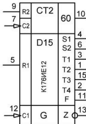
Расположение выводов и условное графическое обозначение.
