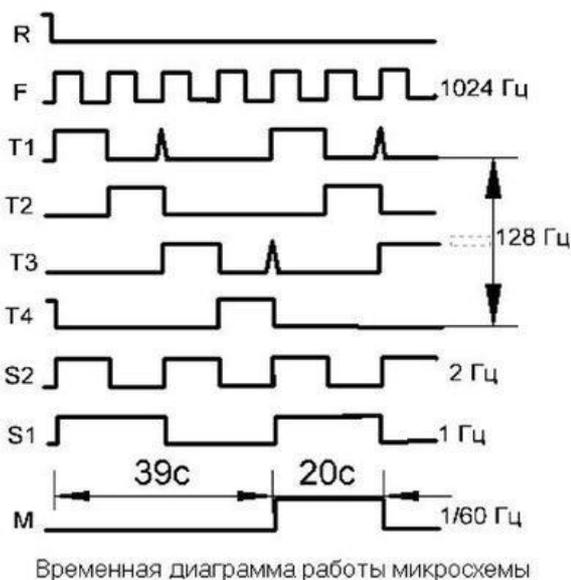
Фазовые соотношения колебаний различных частот относительно момента снятия сигнала сброса продемонстрированы на рисунке, временные масштабы различных диаграмм на этом рисунке различны. При использовании импульсов с выходов Т1 - Т4 для других целей следует обратить внимание на наличие коротких ложных импульсов на этих выходах.
